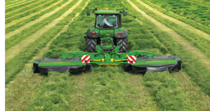
Передне- и задненавесная сдвоенная косилка-плющилка.
